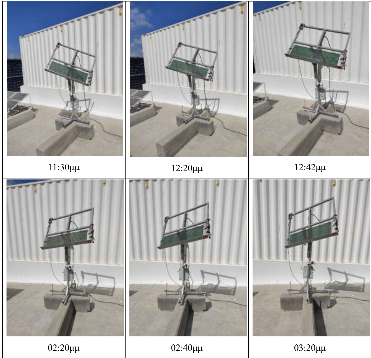
Εικόνα 22. Λειτουργία ηλιακού ιχνηλάτη 2 – αξόνων με εγκατάσταση εύκαμπτου οργανικού Φ/Β κατά τη διάρκεια μίας μέρας
