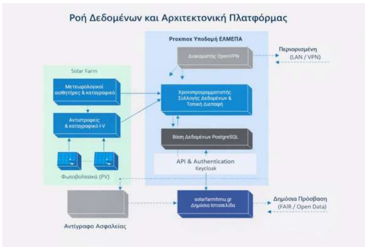
Εικόνα 3 (Block Diagram): η ροή της πληροφορίας από τους αισθητήρες έως την τελική διάθεση των δεδομένων στον χρήστη.
