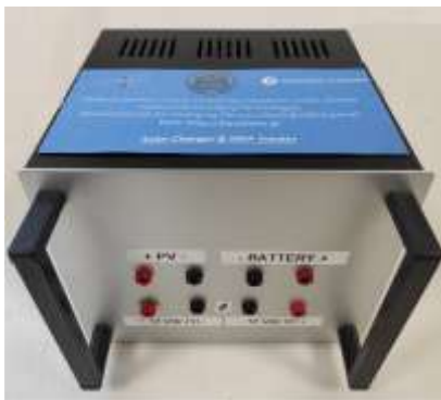
Εικόνα 8 α. Ηλεκτρονικό σύστημα για ανιχνευτή IV-MPP που παρουσιάζεται στον Core 2 b. Γραφική διεπαφή χρήστη (GUI) του ρυθμιστή φορτιστή IV-MPPT
