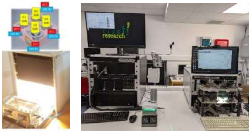
Εικόνα 2 Εξοπλισμός μέτρησης του ΕΛΜΕΠΑ που επιτρέπει την ταυτόχρονη δοκιμή έως και 64 ανεξάρτητων διατάξεων υπό διάφορες συνθήκες (διαφορετική θερμοκρασία, ατμόσφαιρα θαλάμου, φωτισμός φωτός κ.λπ.) προσφέροντας ταχεία προσέγγιση δοκιμών. Ο πύργος LED που αποτελείται από 12 LED επιτρέπει τη μέτρηση της φασματικής απόκρισης και την προσομοίωση πλήρους φάσματος σε συνθήκες ακτινοβολίας 1000\text{W}/\text{m}^2 .
