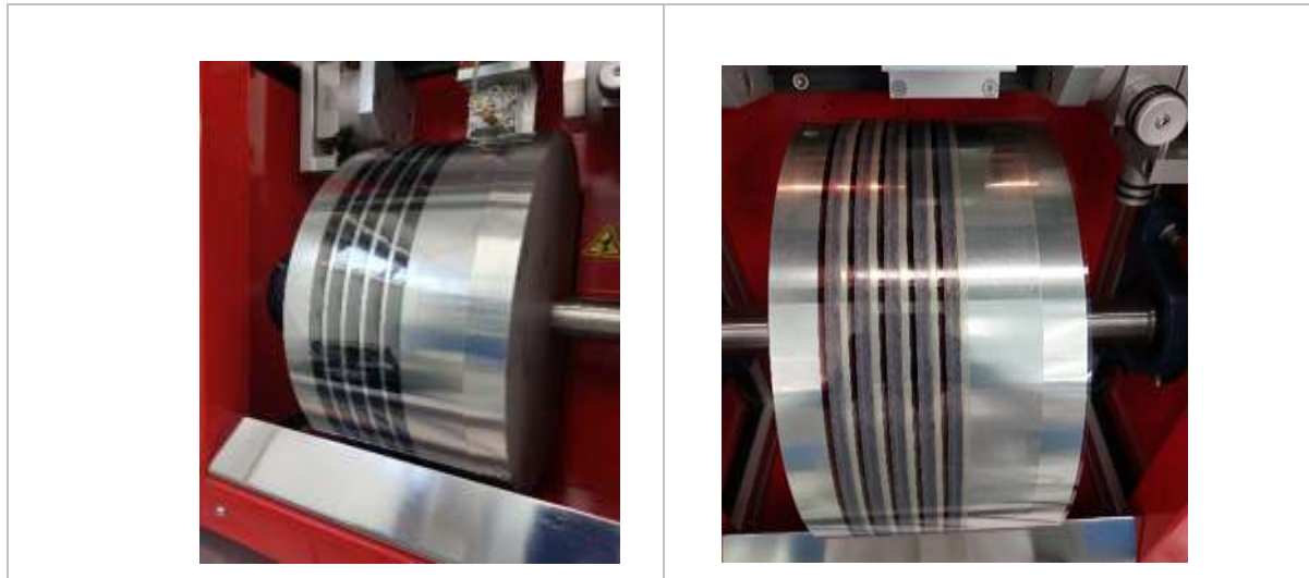
Εικόνα 3.2. α) Slot-die εκτυπωμένα στρώματα με δομή PET/IMI/PEDOT:PSS/MAPbI 3 , β) Slot-die εκτυπωμένα στρώματα με δομή PET/IMI/PEDOT:PSS/MAPbI 3 /PC 60 BM/AgNWs.
