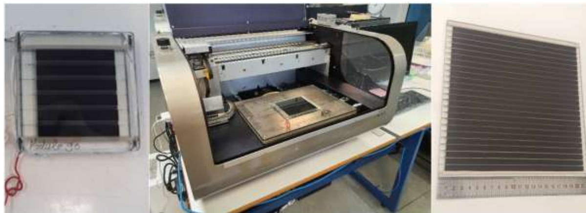
Εικόνα 3.15. Εικόνες από περοβσκιτικές ηλιακές μονάδες διαφορετικών διαστάσεων, 5x5 cm 2 , 10x10 cm 2 και 20x20 cm 2 , που ενσωματώνουν το ηλεκτρόδιο άνθρακα χαμηλής θερμοκρασίας κατεργασίας.
