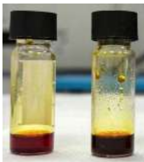
Σχήμα 10. Τα πρόδρομα διαλύματα του περοβσκίτη δομής \text{CH}(\text{NH}_2)_2\text{Pb}_{0.5}\text{Sn}_{0.5}\text{I}_3 σε DMF/DMSO (4:1) (αριστερά) και DMF (δεξιά).
