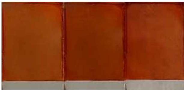
Σχήμα 11. Τα υμένια του περοβσκίτη \text{CH}(\text{NH}_2)_2\text{Pb}_{0.5}\text{Sn}_{0.5}\text{I}_3 σε μίγμα διαλυτών DMF/DMSO (4:1) την 1 η ημέρα (αριστερά), την 7 η ημέρα (κέντρο) και την 14 η ημέρα (δεξιά).
