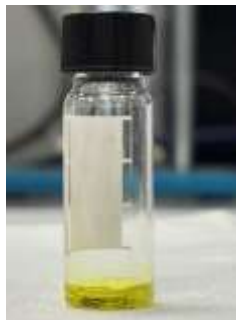
Σχήμα 7. Το πρόδρομο διάλυμα περοβσκίτη δομής CsPbI 3 σε DMF/DMSO σε αναλογία 4:1 v/v.
