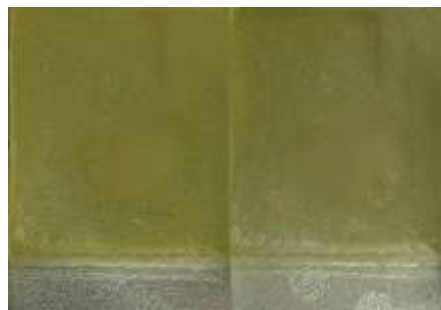
Σχήμα 8. Υμένια περοβσκίτη δομής CsPbI 3 κατά την αποθήκευσή τους σε ατμοσφαιρικές συνθήκες 1 η ημέρα (αριστερά) και 7 η ημέρα (δεξιά).
