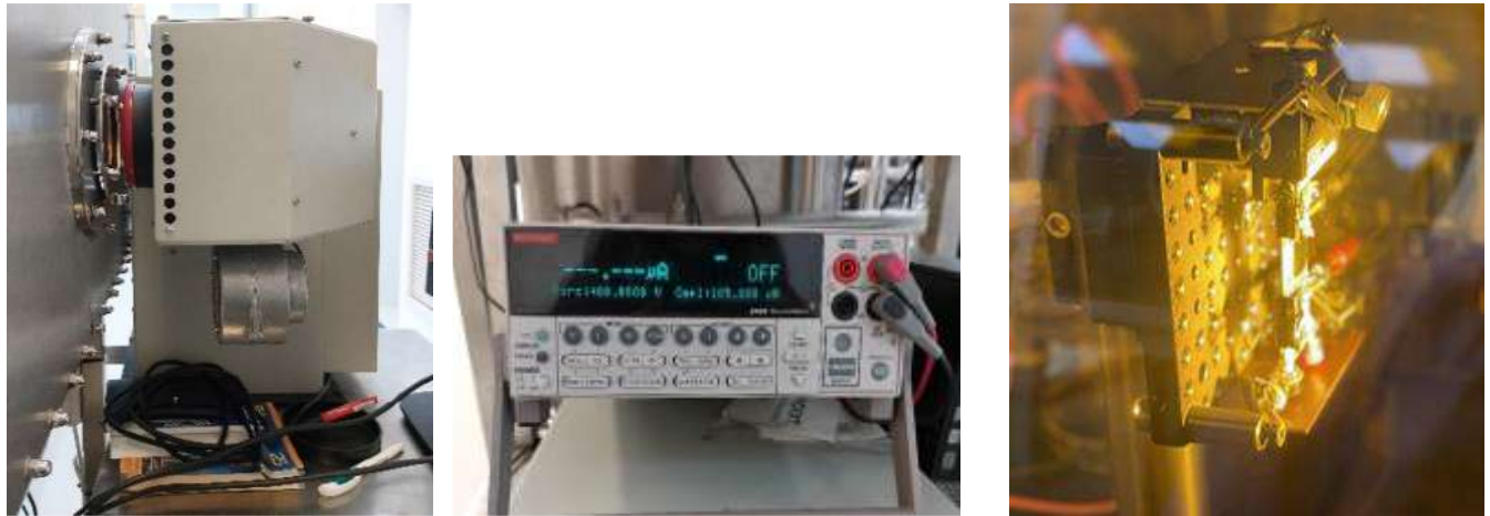
Σχήμα 21. Πειραματική διάταξη Solar Simulator, συστήματος Keithley και βάση ακτινοβολήσης.
