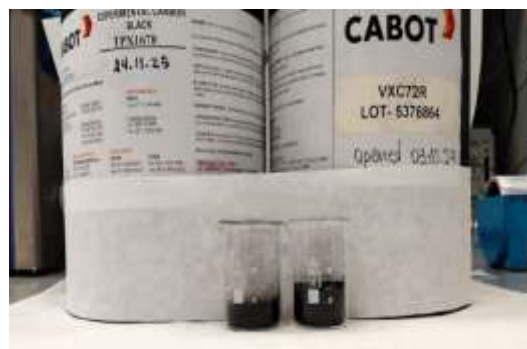
Εικόνα 2.1.44. Εικόνα που δείχνει τους όγκους των συγκρινόμενων σκόνων μαύρου άνθρακα για την ίδια μάζα υλικού.
